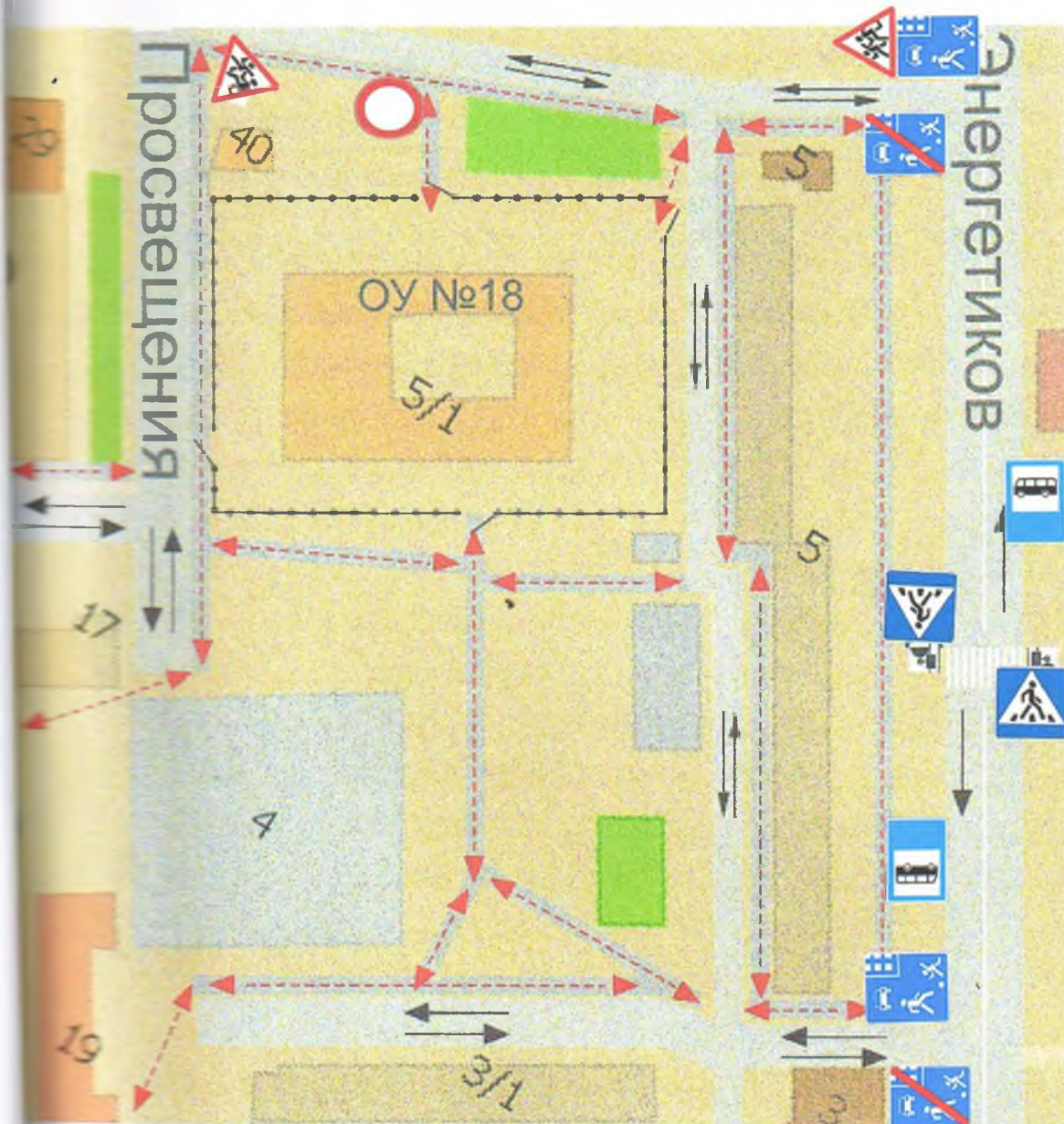
Схема организации дорожного движения в непосредственной близости от образовательного учреждения с размещением соответствующих технических средств организации дорожного движения, маршрутов движения детей (обучающихся, воспитанников) и расположения парковочных мест.
